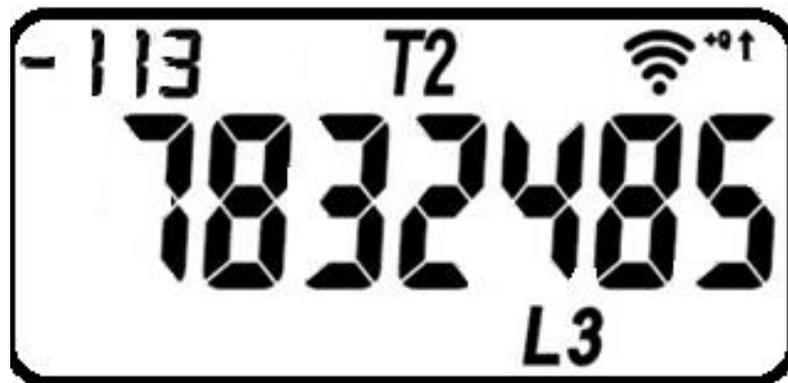
Рисунок 2. Режим отображения id-номера прибора.
